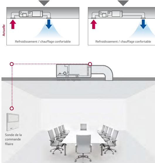
**Contrôle par la double sonde** : en cas d'utilisation de la commande filaire, la température ambiante présente dans les locaux peut être relevée selon 3 modalités différentes :
